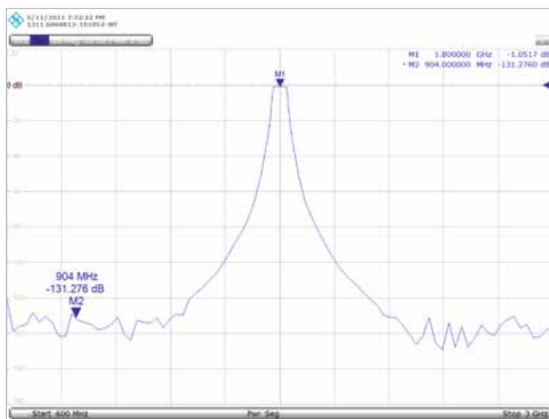
10 Hz の IF 帯域幅でフィルタを測定
