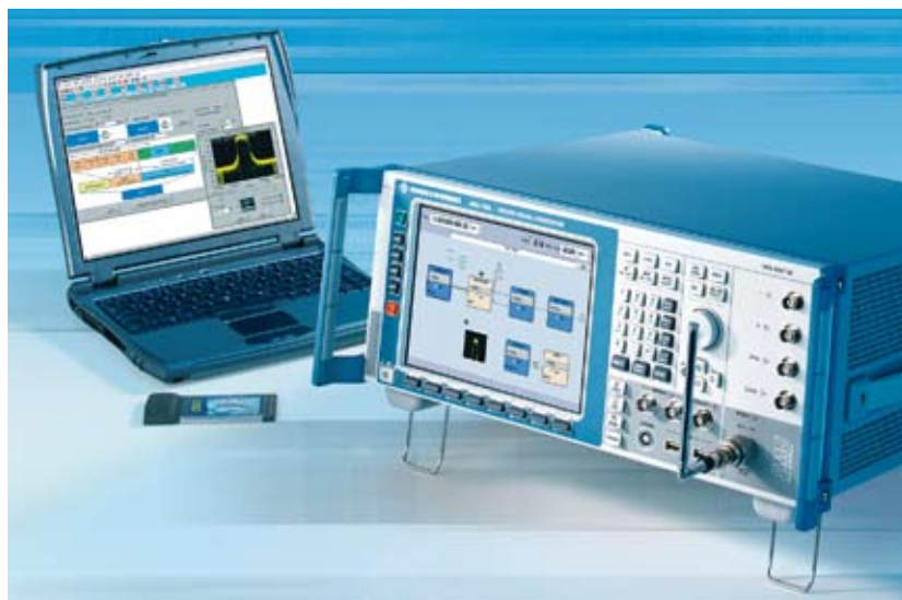
R&S®SMJ100Aを用いて無線LAN(IEEE 802.11)の評価例
