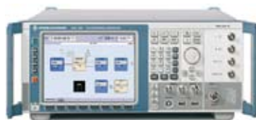
レシーバテスト:R&SRSMJ100Aは、コード・チャンネルの出力パワーを変更することができます。
