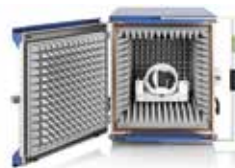
設計予備評価向けコンパクト電波暗箱 R&S®DST200
