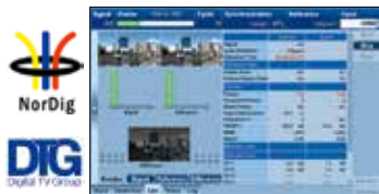
受信機のHDMI出力信号から映像による受信エラー判定を行います
