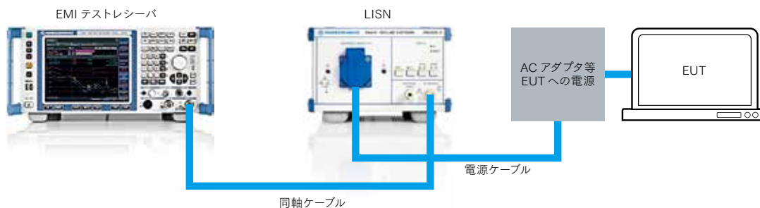
電源線伝導 EMI 測定（端子雑音測定）のセットアップ概要
