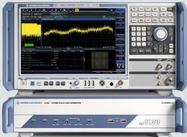
す。47 MHz から 1218 MHz(オプションで 1794 MHz)までのダウンストリーム周波数範囲において、このジェネレータは、最大 8 つの DOCSIS 3.1 チャンネルか、ミックスモード動作の場合で 2 つの DOCSIS 3.1 チャンネルと最大 158 のデジタル TV チャンネルを生成します。アップストリームでは、5 MHz から 204 MHz までの範囲がサポートされており、この範囲には最大帯域幅 96 MHz の DOCSIS 3.1 信号か、DOCSIS 3.0 の TDMA または CDMA 信号を供給できます。
