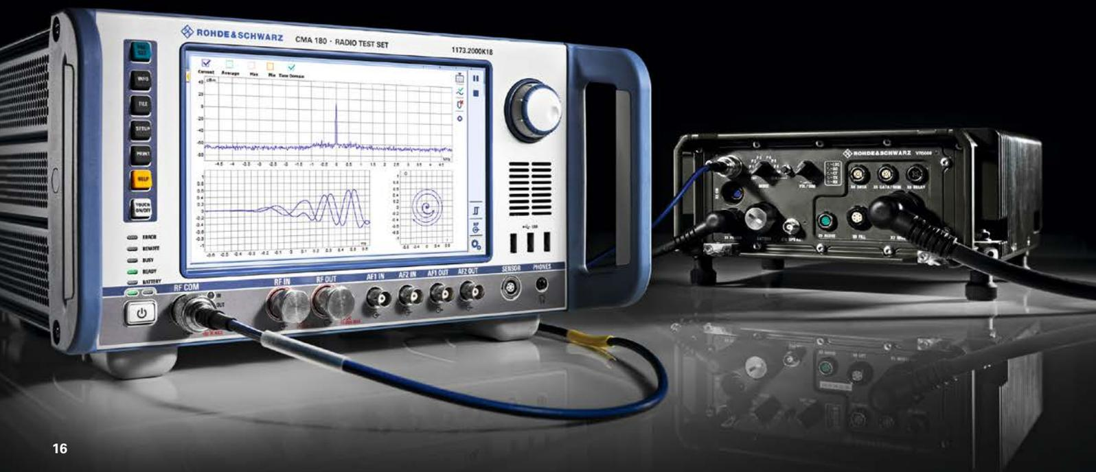
従来のアナログ式および非セルラー方式のデジタル無線を業務で使用する数多くのユーザは、1年前\*に発売された R&S®CMA180 無線テスト・セット(図 1)を無線の修理およびメンテナンスに使用しています。これらのユーザは、すべての関連測定を追加ツールなしで行えることから、必要な機能をすべて備えたこの汎用性の高いテスト・セットを高く評価しています。
