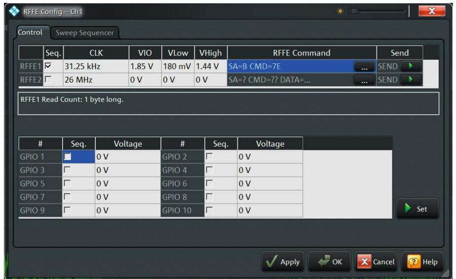
図 3: DUT の特性に合わせて R&S®ZN-B15 MIPI® RFFE インタフェース・カードを構成するためのメニュー
