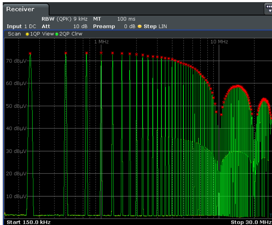
図 16: 信号のスペクトラム測定; QP 検波器; 150 kHz から 30 MHz。
