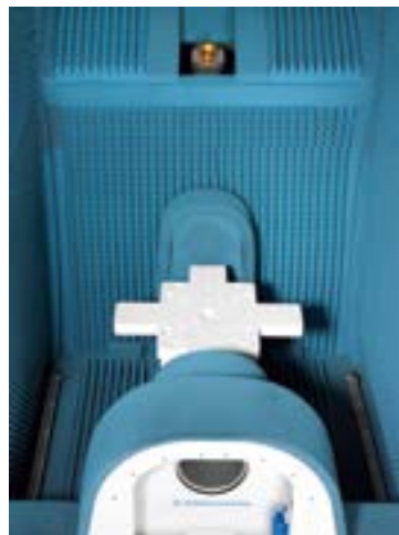
CTIA OTA 試験として仕様化予定のファントムヘッドやファントムハンドのオプションを用意
