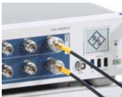
図1：完成したCMP180につなげたキャップナット付きRFケーブル。
