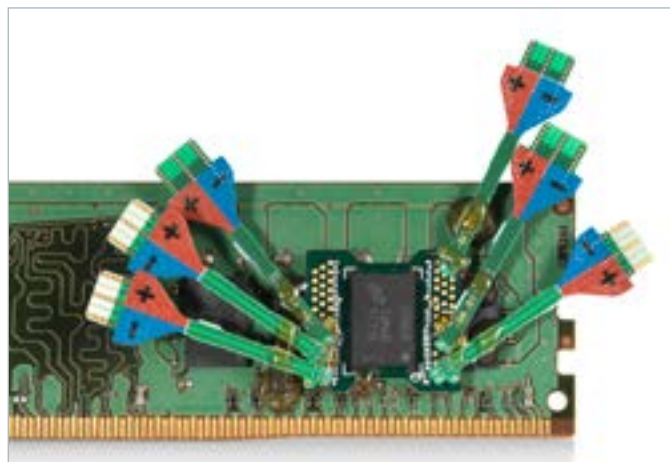
図1: PCB裏面のビアにはんだ付けされたプローブチップ(左)。インターポーザーにはんだ付けされたプローブチップ(右)。
