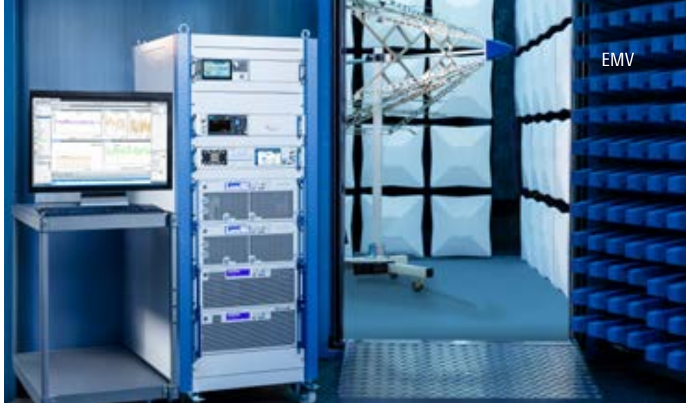
図2：イミュニティーテストシステムの例：この19インチラックには、9 kHz～18 GHzの4つの周波数レンジに対応する広帯域RFアンプ（R&S®BBA300ユニット2台とR&S®BBA150ユニット2台）が収容されています。
